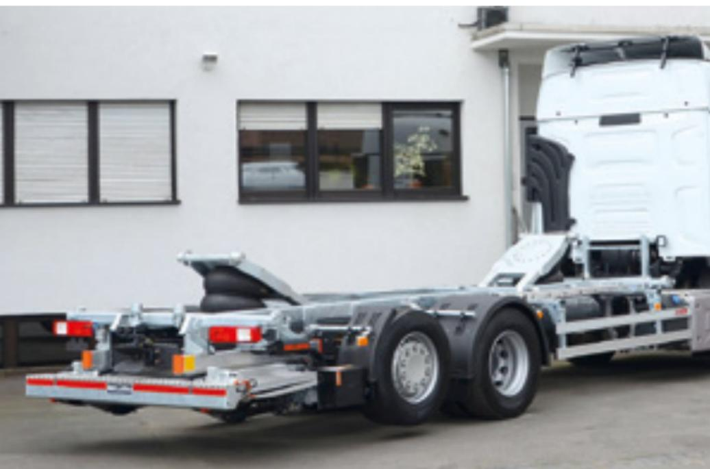
Come le altre sponde DH-SO..., la DH-SO8 è equipaggiata con una **piattaforma doppio ripiegamento**, per consentire l'installazione in uno **sbalzo molto corto**. A differenza degli altri tipi, la piattaforma della DH-SO8 è composta da 3 sezioni: una robusta sezione in acciaio fissa, che funge anche da paraurti; e 2 sezioni ripieghevoli di alluminio leggero.
